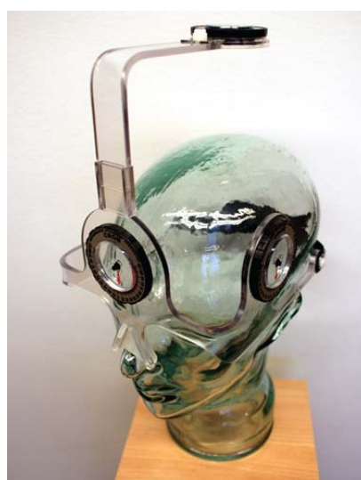
CROM kaularangan liikkuvuuden mittauskypärä. 2 kallistusmittaria ja 1 kompassi. Kaikki liikesuunnat voidaan mitata yhdellä asetuksella.
