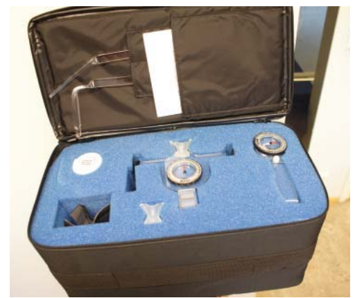
CROM kaularangan liikkuvuuden mittauskypärä. 2 kallistusmittaria ja 1 kompassi. Kaikki liikesuunnat voidaan mitata yhdellä asetuksella.
