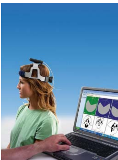
Elektroninen kaularangan liikkuvuuden mittaustaite ja ohjausohjelma.
